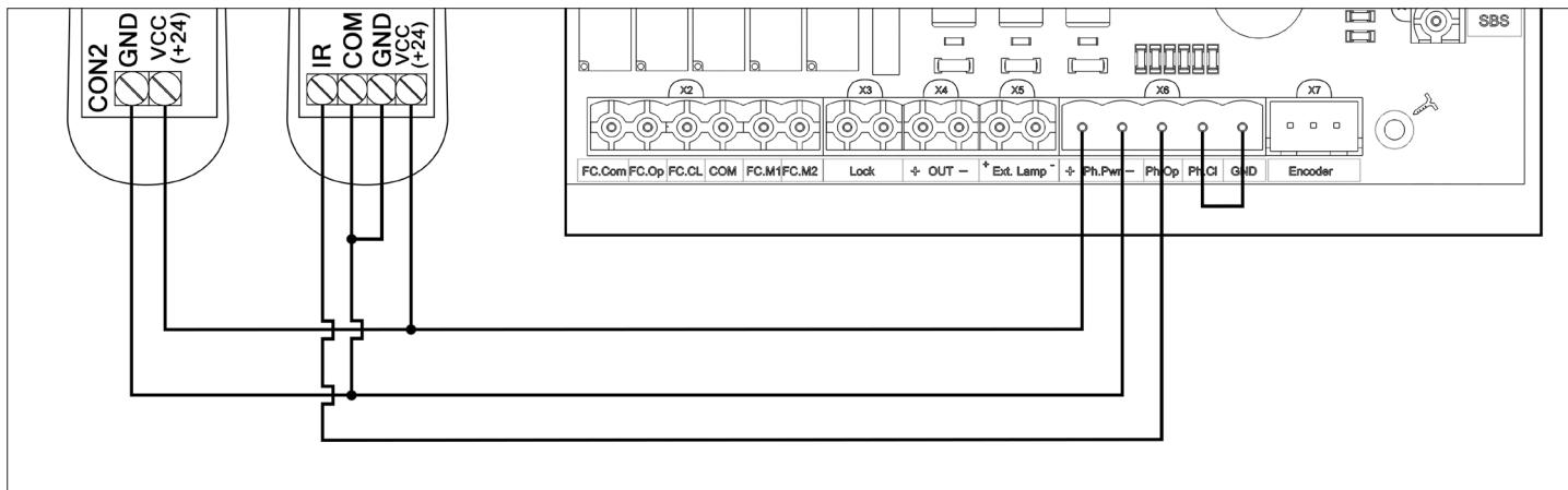
Схема подключения фотоэлементов на открывание.
