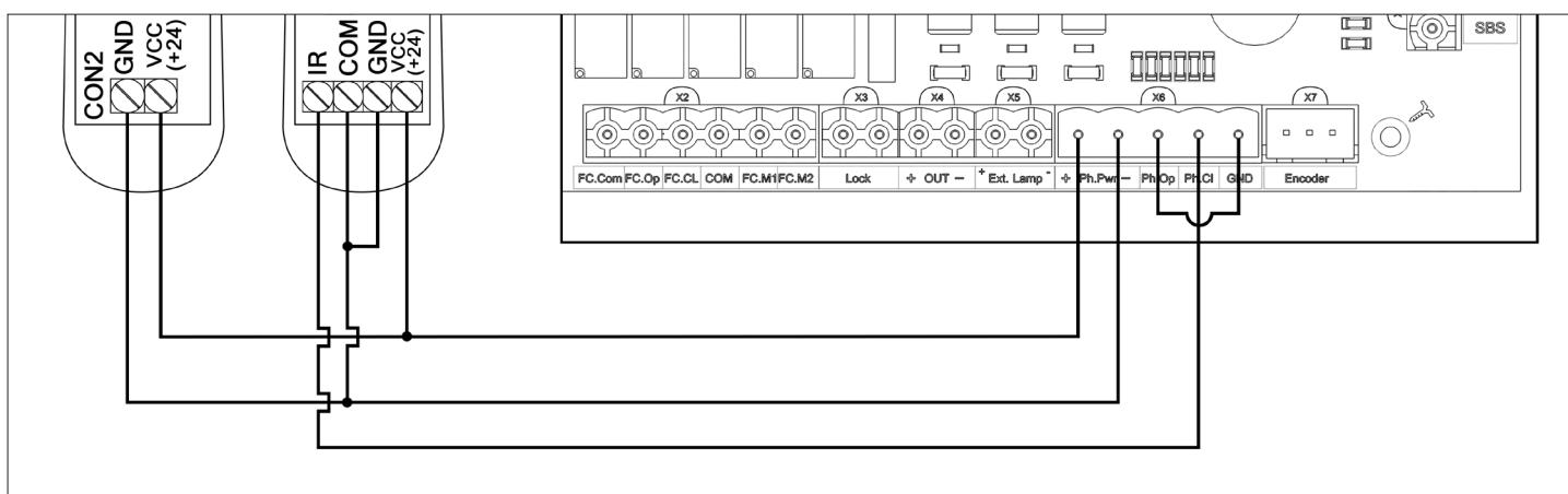
Схема подключения фотоэлементов на закрывание.
